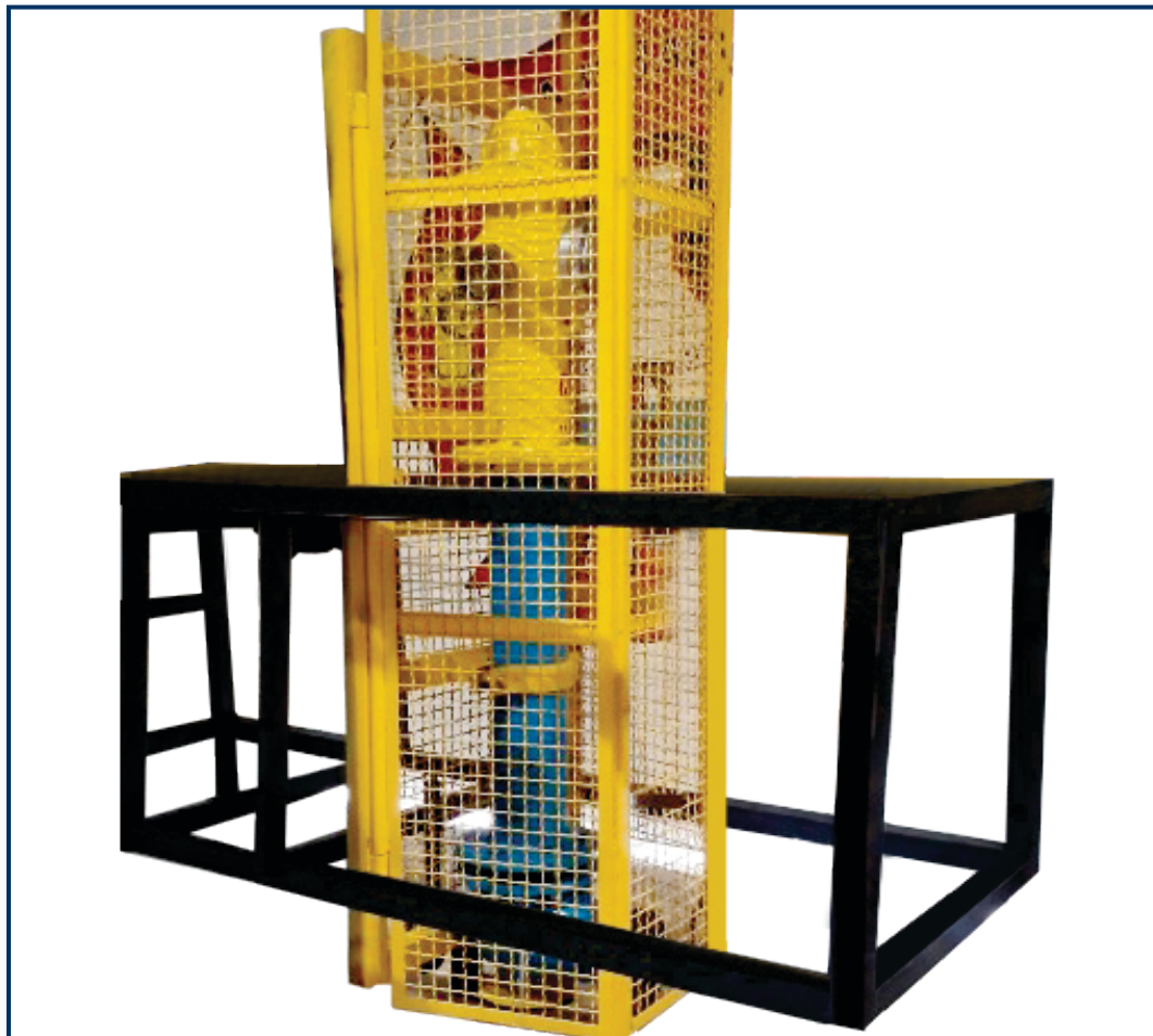
آزمون تخلیه خودکار هایدرانت Automatic hydrant drainage test
